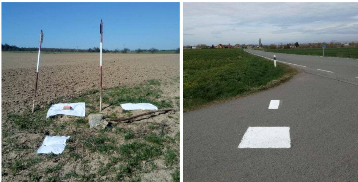
Obr. 5: Ukázka signalizace vřícovacích bodů v období 2012 - 2020
